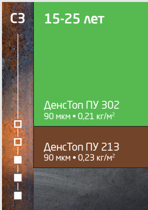
АНТИКОРРОЗИОННАЯ СИСТЕМА С3.06 Тип 3
