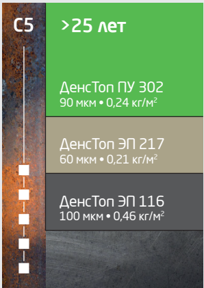
АНТИКОРРОЗИОННАЯ СИСТЕМА C5.08 Тип 3
