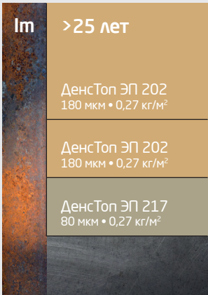
АНТИКОРРОЗИОННАЯ СИСТЕМА I.03 Тип 2
