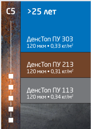
АНТИКОРРОЗИОННАЯ СИСТЕМА C5.04 Тип 2
